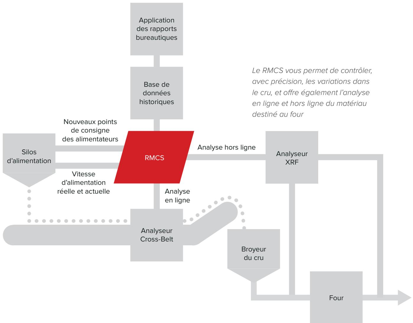
L'algorithme de contrôle de RMCS comprend un calcul d'aptitude qui détermine une solution optimale. Les points de consigne résultants des alimentateurs sont envoyés automatiquement au système de commande de processus (PCS).
